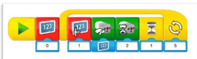
Esta programação irá começar exibindo o n.º 0 na tela. Depois, repetirá uma série de ações cinco vezes. Adicionará ao visor o n.º 1, o que se tornará a magnitude de estremecimento, ligará o motor para aquela magnitude por 2 seg. e, depois, aguardará 1 seg.
